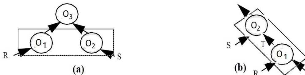
FIGURE 4.6 - Parallélisme inter-opérateurs : (a) indépendant (b) et pipeline.
